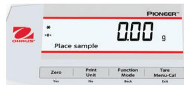
Grand angle de lecture grâce à un affichage LCD rétroéclairé et lumineux. L'afficheur à 2 lignes fournit rapidement des informations ou des conseils supplémentaires à l'utilisateur. La barre de capacité affiche la progression de la pesée.
