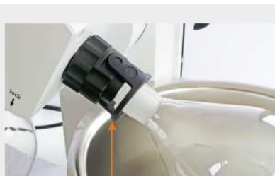
EASY CLIP geschlossen, Verdampfungskolben gesichert
