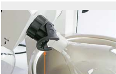
EASY CLIP offen, Verdampfungskolben ungesichert
